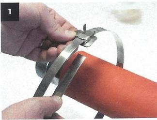
Schlaufe mit den Ohren zum Bandende auf das Band ziehen. Schelle formen und Band auf Band legen. Schlaufe über beide Bänder ziehen, und das Bandende ca. 30 mm unter die Schlaufe biegen.
