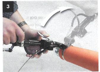
Band in das Spannwerkzeug seitlich einführen, Exzenterhebel andrücken, und durch Drehen der Kurbel Schelle anziehen. Die maximale Spannung ist erreicht, wenn das Band nicht mehr unter der Schlaufe durchzieht. Nach Erreichen der erforderlichen Spannung das Werkzeug langsam über die Schlaufe biegen. Dabei gleichzeitig die Kurbel um ca. eine halbe Umdrehung lösen, um Spannungsverlust und Reißen des Bandes zu vermeiden.
